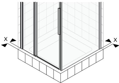
Montage bodengleich bezogen auf Außenkante Wandprofil (ohne Rücksprung)
