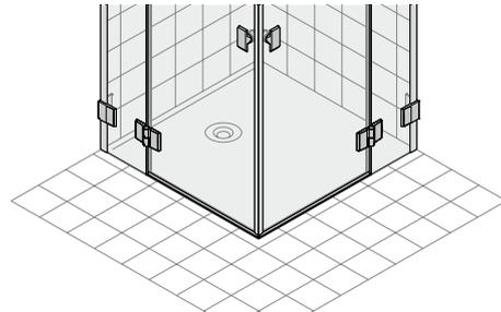
Montage auf Duschwanne/Sockel bezogen auf Außenkante Wandprofil (mit Rücksprung = x)
