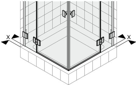
Montage bodengleich bezogen auf Außenkante Glas (ohne Rücksprung)
